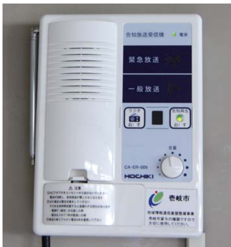
FMラジオを組み込んだ受信機(FM告知器)
