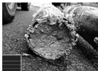
主に食用油を流されたことが原因による汚水管閉塞状況
